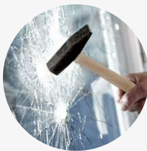
Vetri resistenti all'effrazione secondo UNI EN 356 classe P5A
